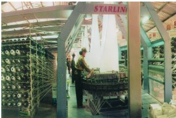
Máy dệt 6 thoi Staslinges của Đức, Ấn Độ, trong dây chuyền sản xuất nhựa bao bì
